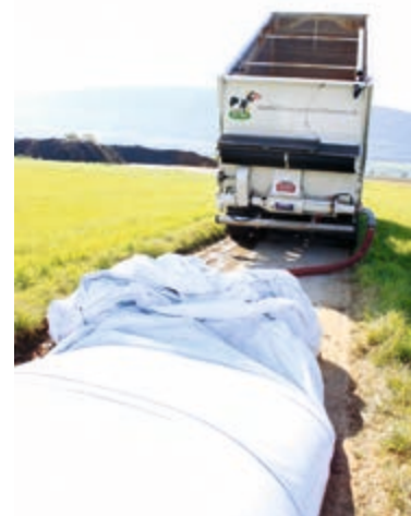
Les drêches fraîches, au départ de la production, sont livrées fco ferme et sont pompées dans un silo ou comme ici dans un silo-boudin.
